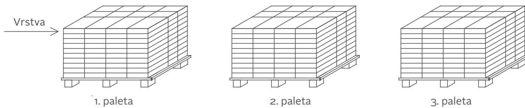
Pri uložení a napojení vrstiev stačí vymeniť posledné kusy v prvom a druhom rade navzájom – tým sa vytvorí väzba (prepojenie) aby nevznikali zvislé línie v dlažbe. Pri spojení potom treba doplniť jeden väčší rozmer z ďalšieho radu aby sa celok uzavrel a takto pokračovať po celej dĺžke.
